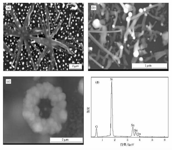
图 3 部分样品的 SEM 照片和 EDS 图 (a)SnO<sub>2</sub> 纳米花(样品 6-1 #)的 SEM 照片(b)SnO<sub>2</sub> 纳米棒(样品 1-1 #)的 SEM 照片(c)SnO<sub>2</sub> 亚微米环(样品 3-1 #)的 SEM 照片(d)SnO<sub>2</sub> 亚微米环的 EDS 图
