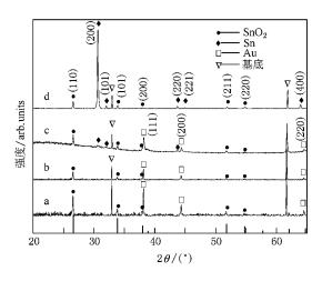
图 1 不同条件下制备  ${\rm SnO_2}$  微纳米结构的 XRD 图谱 曲线 a、曲线 b、曲线 c 和曲线 d 分别对应于 1-3 # ,1-1 # b-1 # 和 3-1 # 样品
